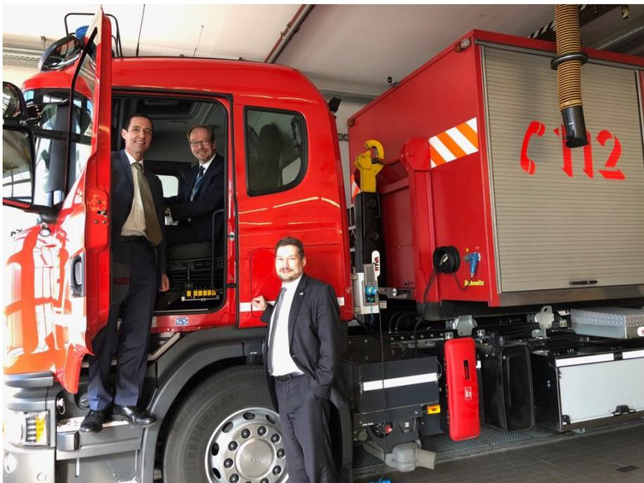
Bei dem Wechselladerfahrzeug handelt es sich um ein Feuerwehrfahrzeug für den Transport von Abrollbehältern zur Einsatzstelle. Beim Löschzug Bergheim ist der kreiseigene „Abrollbehälter Gefahrgut“ stationiert, der über Gerätschaften zur Durchführung von umfangreichen Sofortmaßnahmen bei der Bekämpfung von Unfällen mit gefährlichen Stoffen und Gütern verfügt.
