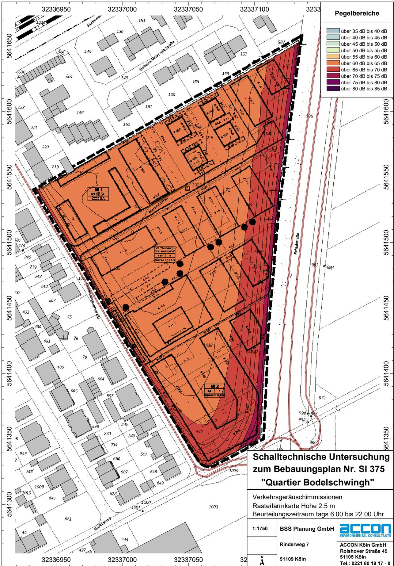
**Abb. 3.4.2** Darstellung der Verkehrsgeschmmissionen innerhalb des Plangebiets tags in Form einer Lärnkarte für eine freie Schallausbreitung in einer Höhe von 2,5 m (EG)
